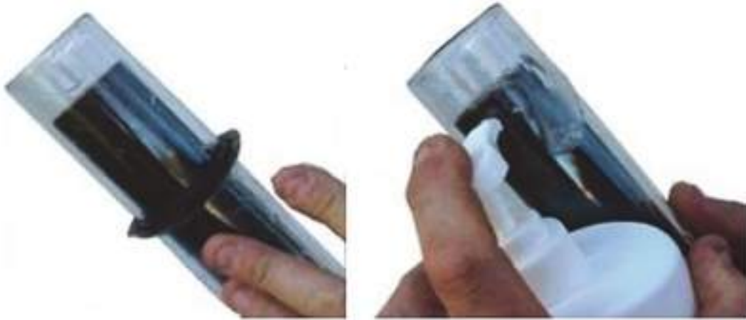
Նկ. 3.14.5. Վակուումային խողովակի վերին հասվածի ծածկում հեղուկ օձառով
