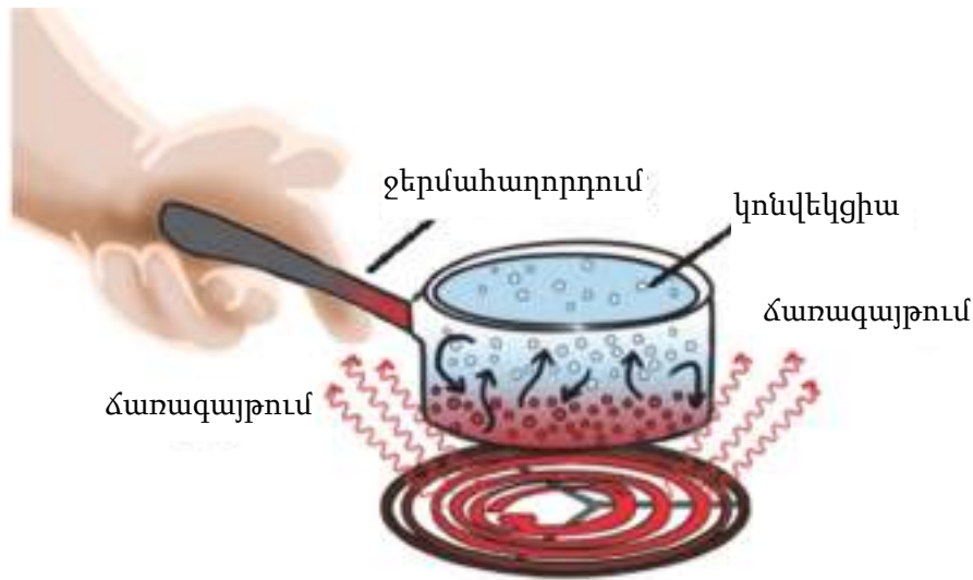
Նկ. 2.1.2. Ջերմային էներգիայի տաք մարմնից սառին փոխանցման երեք ձևը
