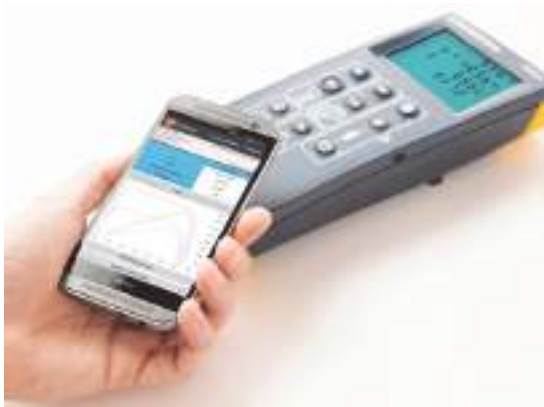
Նկ. 7.2.2. Ֆոտովոլտային մոդուլների բնութագրերը չափող սարք և չափված վոլտ – ամպերային և հզորության բնութագրերը
