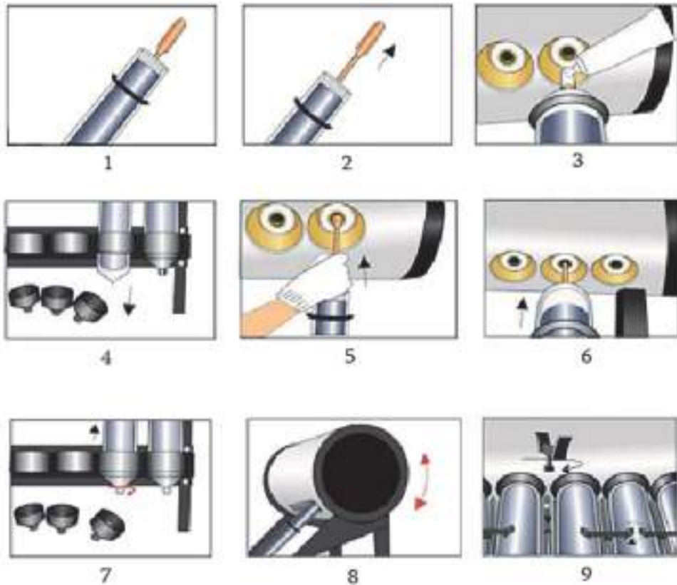
Նկ. 3.14.9. Ջերմային խողովակներով համակարգի մոնտաժ.
