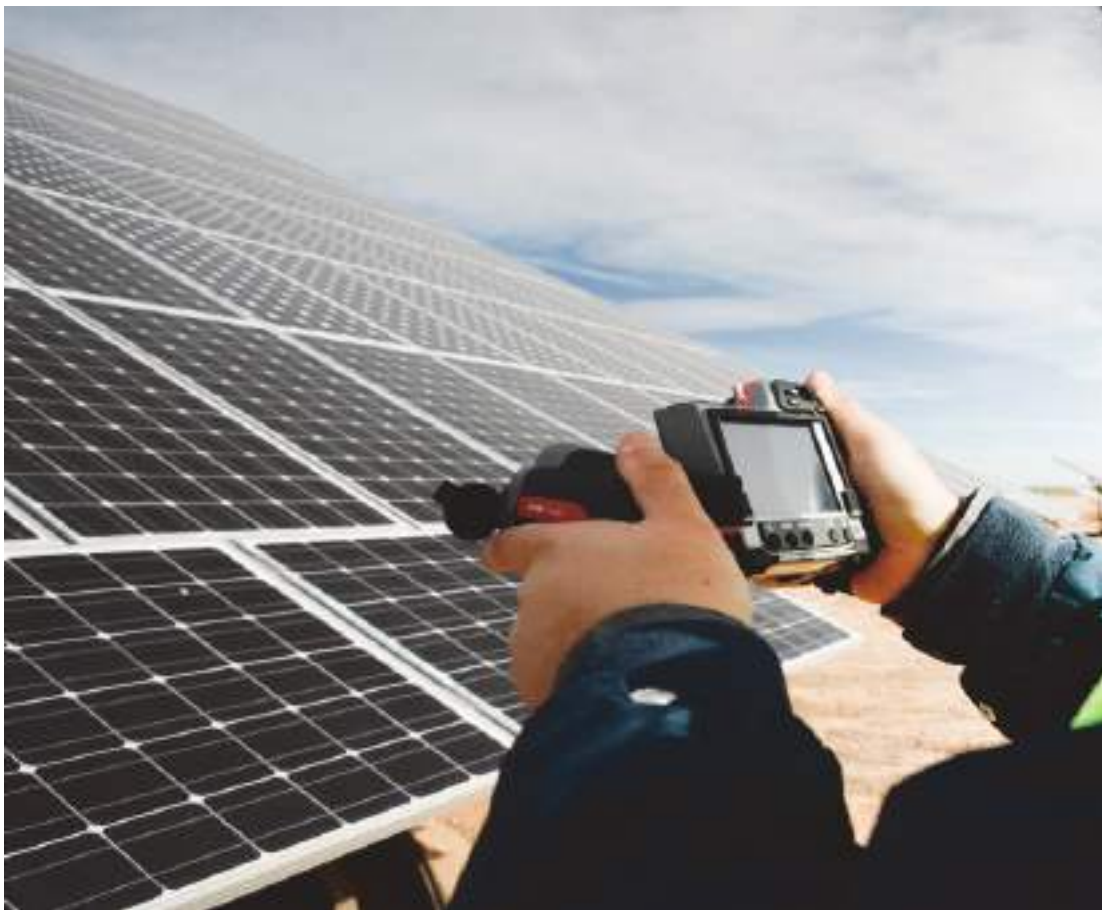
Նկ. 7.4.4. Արևային մոդուլների նկարահանումը ինֆրակարմիր տեսախցիկի միջոցով
