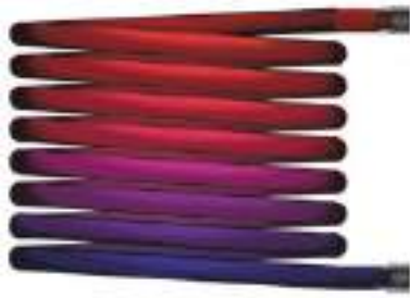
Նկ. 2.6.2. Բաքի մեջ տեղադրվող ջերմափոխանակիչ
