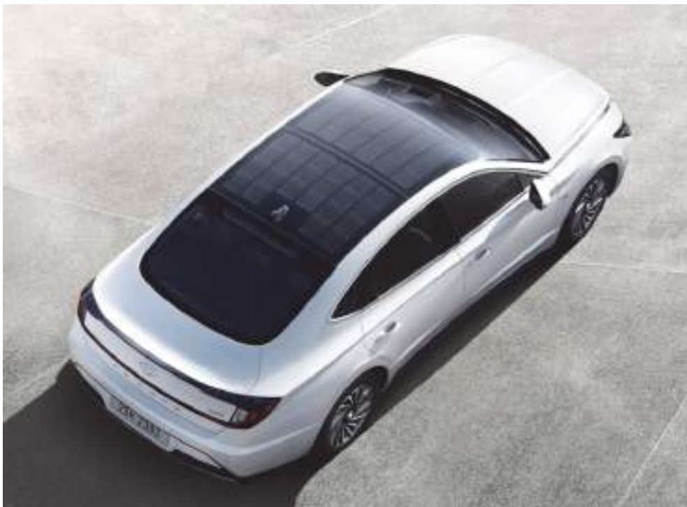
Նկ. 1.4.14. Արևային մարտկոցներով սնուցվող էլեկտրական մեքենա
