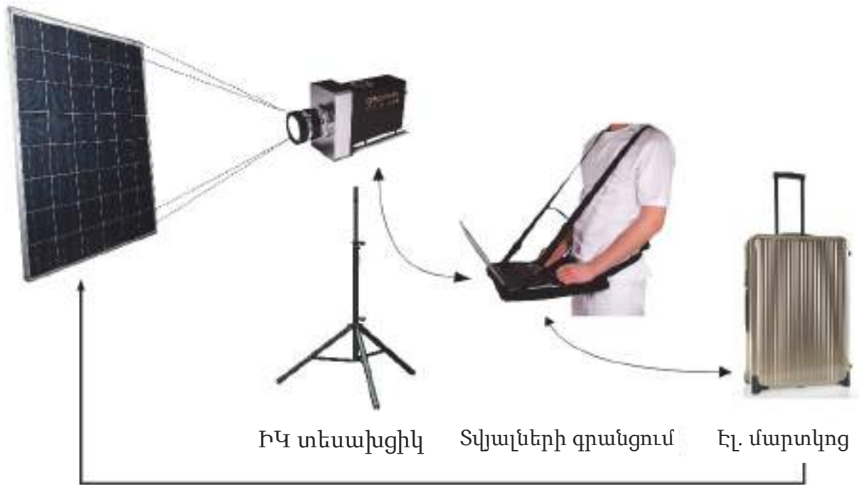
Նկ. 7.2.6. Արևային ֆոտովոլտային մոդուլների հետագոտում էլեկտրայումինեցենտային մեթոդով
