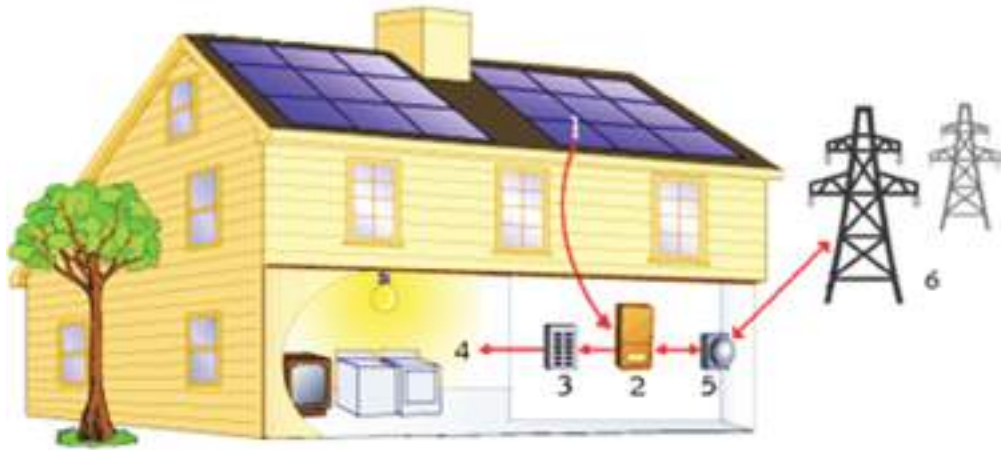
Նկ. 5.6.1. Էլեկտրական ցանցին միացված արևային ֆոտովոլտային համակարգ. 1 - արևային մոդուլների զանգված, 2 - ինվերտոր, 3 - անջատիչ տուփ, 4 - կենցաղային էլեկտրական տեխնիկա, 5 - երկկողմանի էլեկտրահաշվիչ, 6 - էլեկտրացանց
