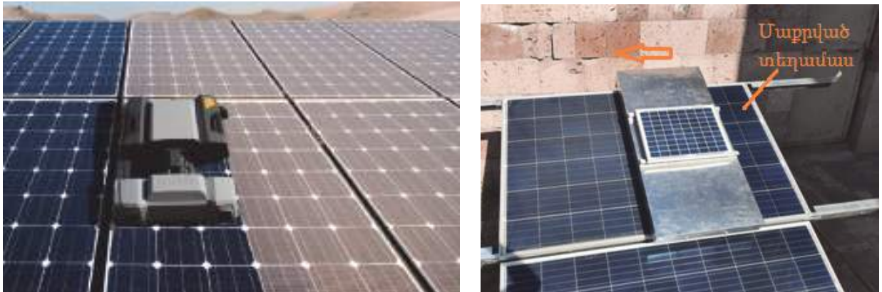
Նկ. 7.4.3. Ռոբոտների միջոցով ֆոտովոլտային մոդուլների չոր մաքրում
