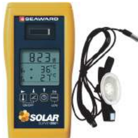
Նկ. 7.2.3. Արևի ճառագայթների ինտենսիվությունը չափող սարք
